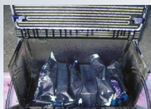
Transportkoffer ohne Pyrotechnik nach dem Auslösen
